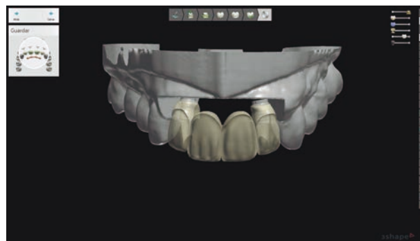
FIG. 28. Diseño digital de la estructura de zirconia con cut-back.
